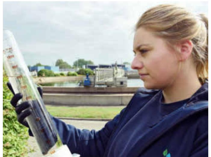
Wiebke Wuchsa muss täglich Abwasserproben aus der Kläranlage nehmen und im Labor untersuchen, damit mögliche Umweltbelastungen schnell erkannt und vermieden werden können.
